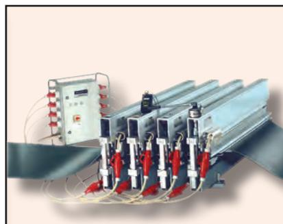
9. Все штекерные комплекты соединяются с распределительными шкафами. Их подключают к электросети. Начинается процесс нагрева. Температурные щупы термометров вставляет в предназначенные отверстия нагревательных / прессующих листов.
