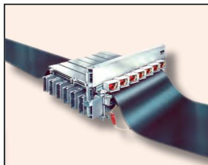
9. В заключении укладываются верхние траверсы со своими нажимными элементами. Задвинете стяжные болты в сборе сразу с обеих сторон чтобы воспрепятствовать наклонению профилей траверс. Обратите внимание на то, чтобы все манометры находились на одной стороне.
